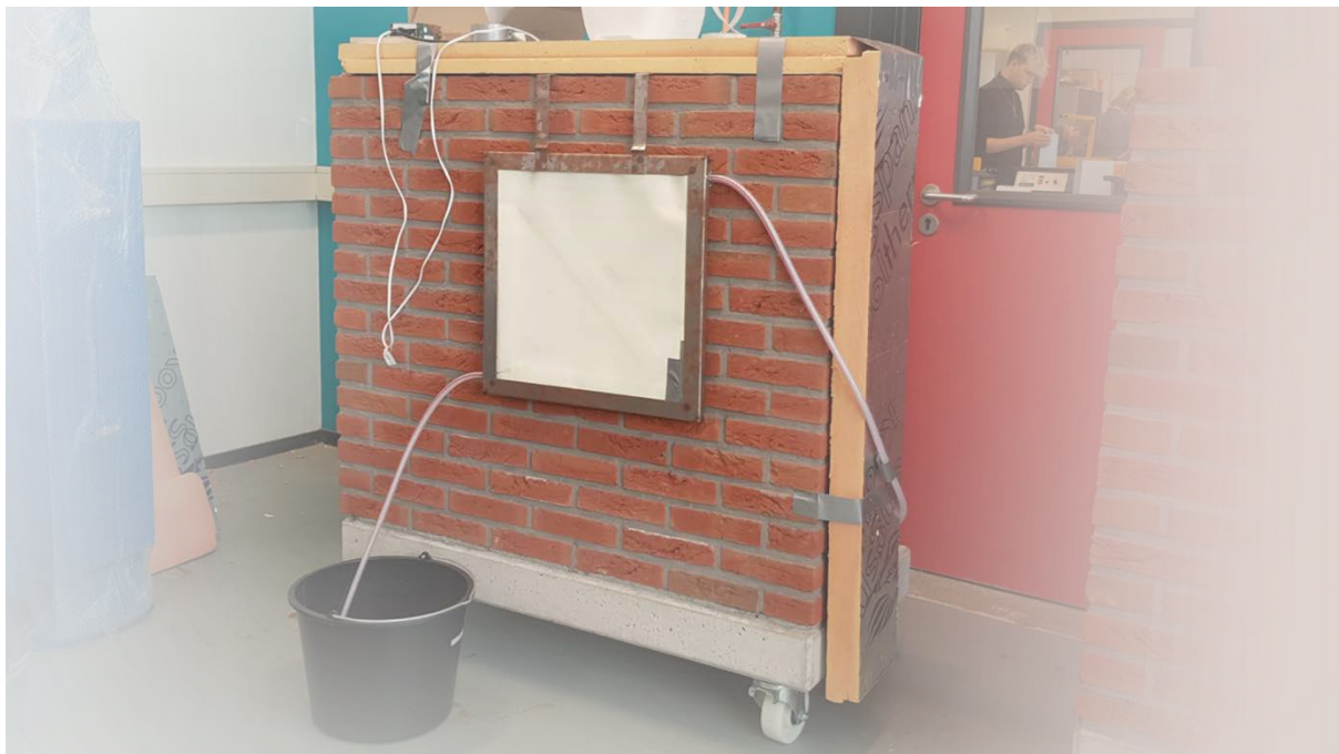
Afb 1. Het prototype van het textielpaneel op de externe wand
